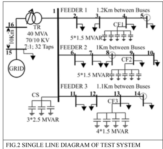
FIG.2 SINGLE LINE DIAGRAM OF TEST SYSTEM
