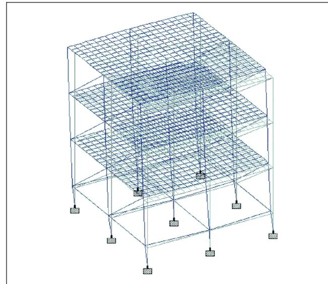
FIG. 5 II MODE IN IN-PLANE: 10.47 Hz
