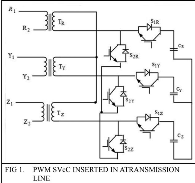
FIG 1. PWM SVcC INSERTED IN A TRANSMISSION LINE
