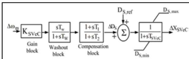
FIG 4. BLOCK DIAGRAM OF SVcC DANPING CONTROLLER
