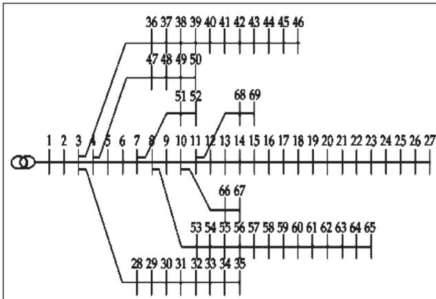
FIG. 5 SINGLE-LINE DIAGRAM OF 69BUS SYSTEM
