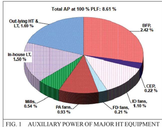
FIG. 1 AUXILIARY POWER OF MAJOR HT EQUIPMENT
