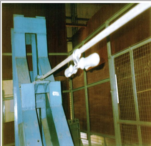
FIG. 4 DAMPER ATTACHED ON RE CONDUCTOR UNDER TEST
