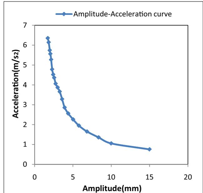
FIG. 9 ACCELERATION CURVE W.R.T. AMPLITUDE OF DAMPER VIBRATION
