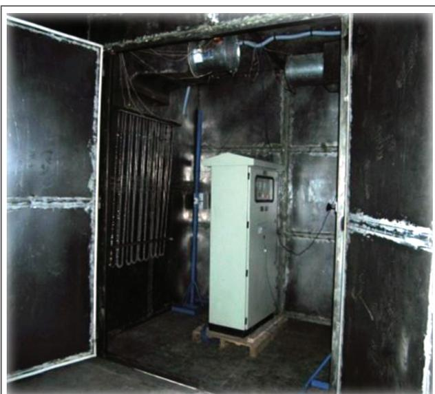
FIG. 3 DISTRIBUTION BOARD UNDER TEST ASSEMBLE INSIDE AN HOT OVEN
