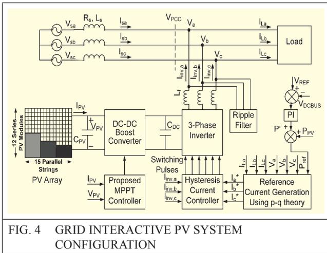
FIG. 4 GRID INTERACTIVE PV SYSTEM CONFIGURATION
