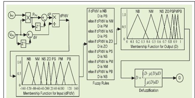
FIG. 3 PROPOSED FUZZY LOGIC CONTROLLER FOR TRACKING GPP
