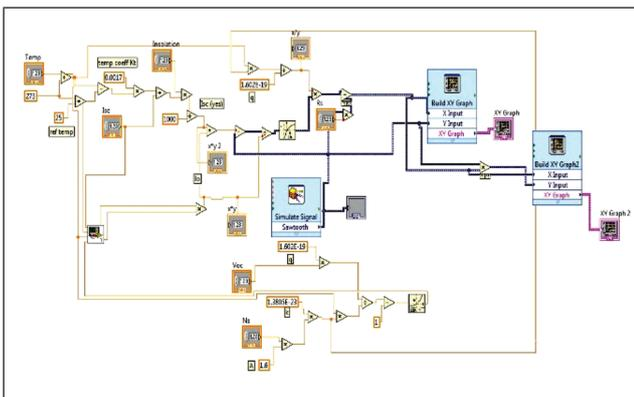
FIG. 6 SOLAR PV SIMULATION MODEL IN LAB VIEW
