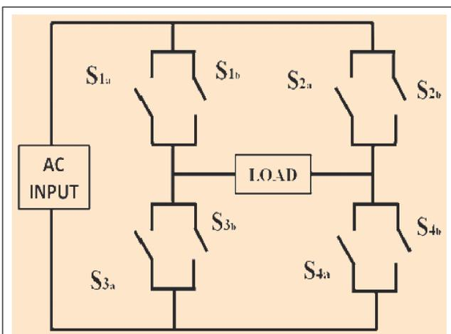
FIG. 4 SINGLE PHASE MATRIX CIRCUIT CONVERTER
