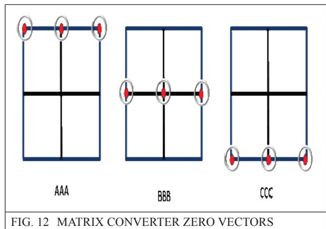
FIG. 12 MATRIX CONVERTER ZERO VECTORS
