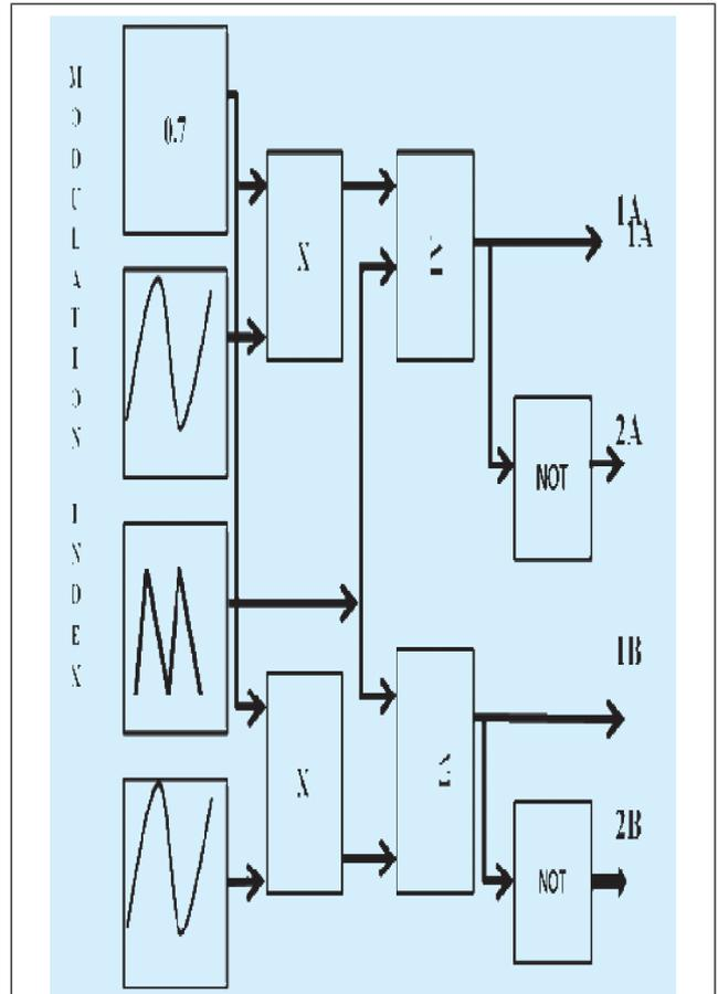
FIG. 9 GENERATION OF SINUSOIDAL PULSE WIDTH MODULATION GATE PULSE
