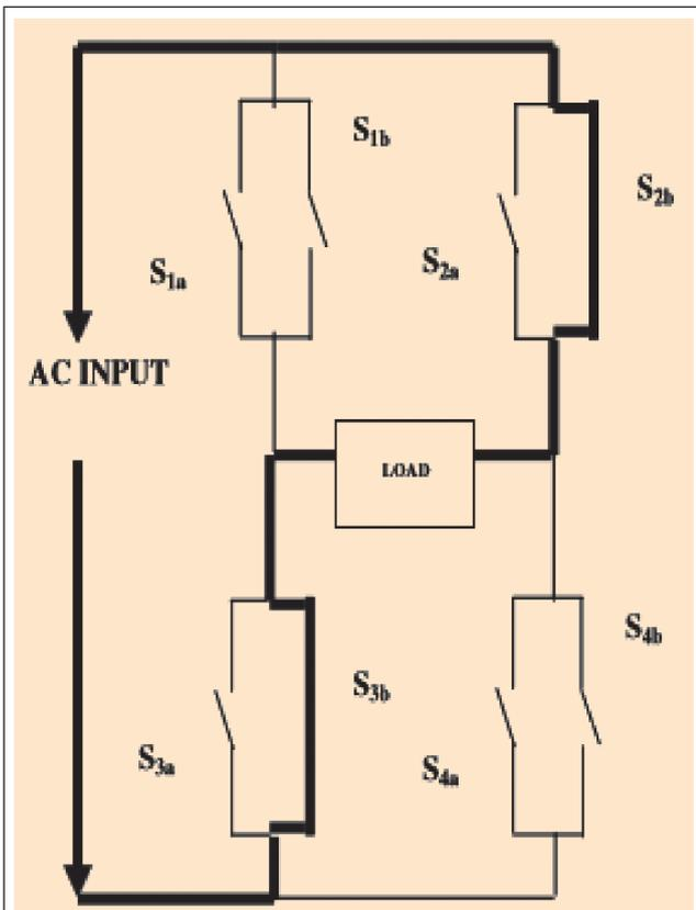
FIG. 8 S<sub>2B</sub> AND S<sub>3B</sub> SWITCHED ON DURING NEGATIVE HALF CYCLE
