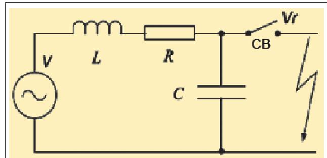
FIG. 1(A) SINGLE PHASE EQUIVALENT -TYPICAL NETWORK
