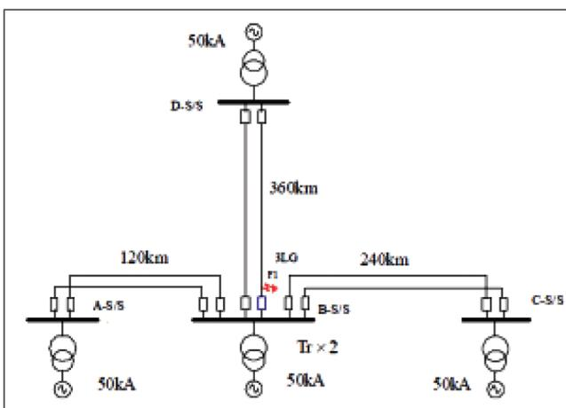
FIG. 6 TYPICAL 1100 KV SYSTEM – CIGRE MODEL
