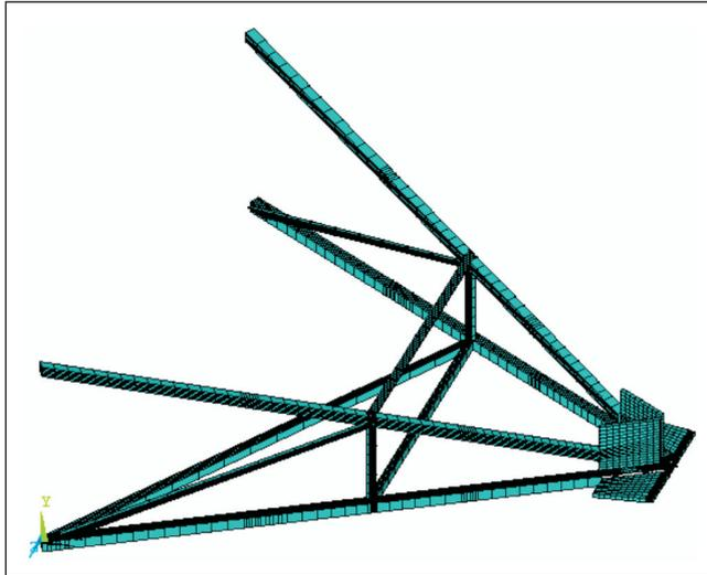
FIG. 2 GEOMETRIC MODEL OF FRP CROSS ARM
