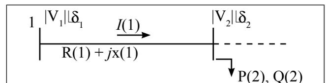
FIG. 1 ELECTRICAL EQUIVALENT OF A TYPICAL BRANCH
