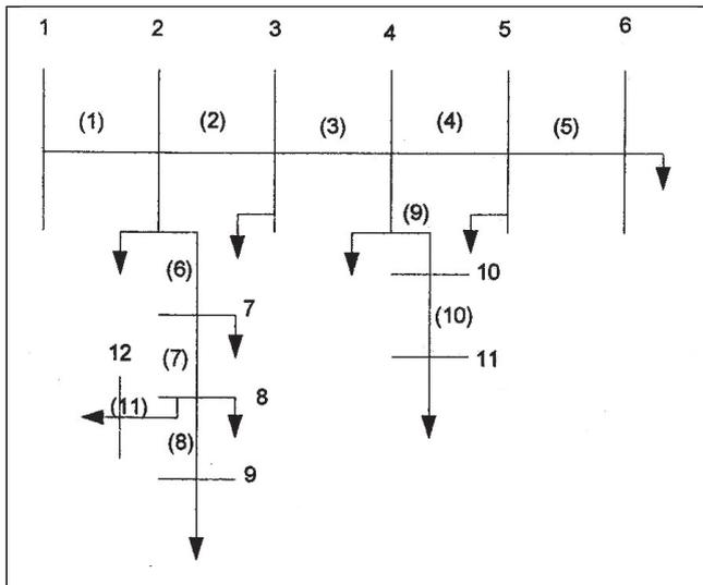
FIG. 2 SINGLE-LINE DIAGRAM OF RADIAL DISTRIBUTION NETWORK
