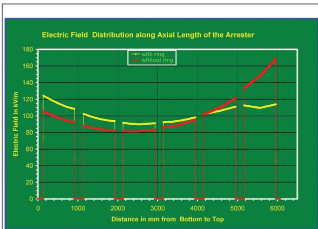
FIG. 4 COMPUTED VOLTAGE DISTRIBUTION ALONG THE AXIAL LENGTH OF THE 624 kV ARRESTER
