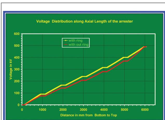
FIG. 5 COMPUTED ELECTRIC FIELD DISTRIBUTION ALONG THE AXIAL LENGTH OF THE 624 kV ARRESTER
