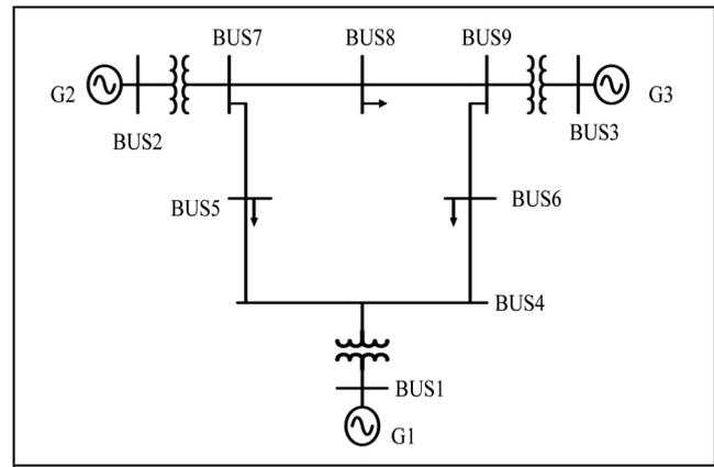
FIG. 3 3 MACHINE 9-BUS SYSTEM.
