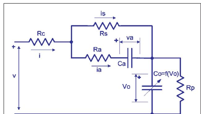
FIG. 2. EQUIVALENT CIRCUIT OF LITHIUM ION CAPACITOR[6]
