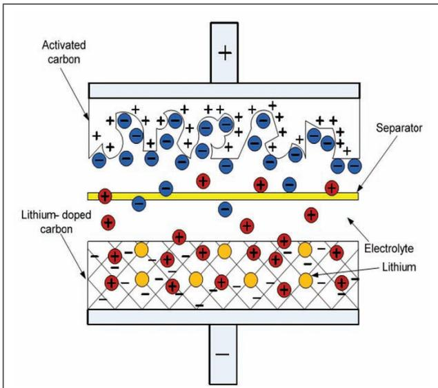
FIG. 1. LITHIUM ION HYBRID ULTRACAPACITOR (LI-ION HUC)
