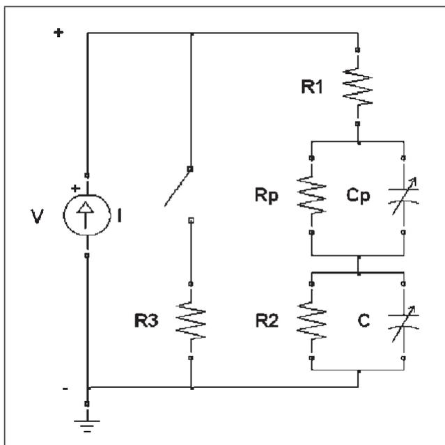
FIG. 3. PSPICE BASED FUNDAMENTAL ELECTRICAL DOUBLE LAYER CAPACITOR / HYBRID CAPACITOR CIRCUIT
