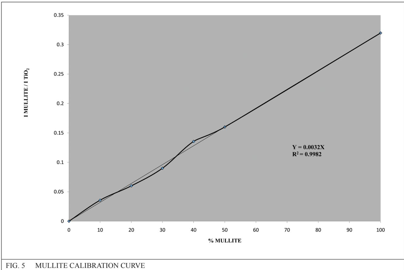
FIG. 5 MULLITE CALIBRATION CURVE
