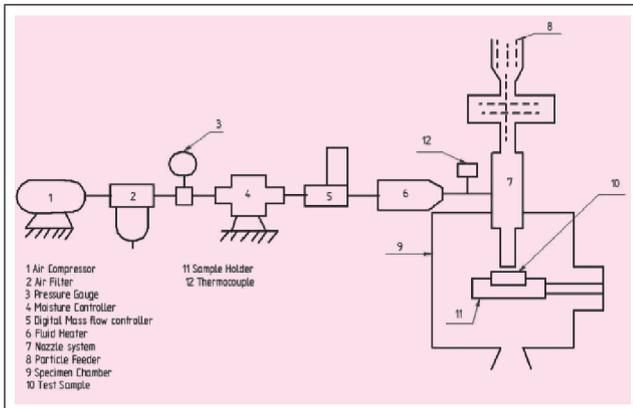
FIG. 1 SCHEMATIC VIEW OF HIGH TEMPERATURE AIR JET EROSION TEST RIG
