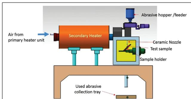
FIG. 1 SCHEMATIC VIEW OF HIGH-TEMPERATURE EROSION TEST RIG
