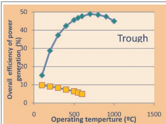
FIG. 2. OVERALL SOLAR CONCENTRATING POWER PLANT EFFICIENCY
