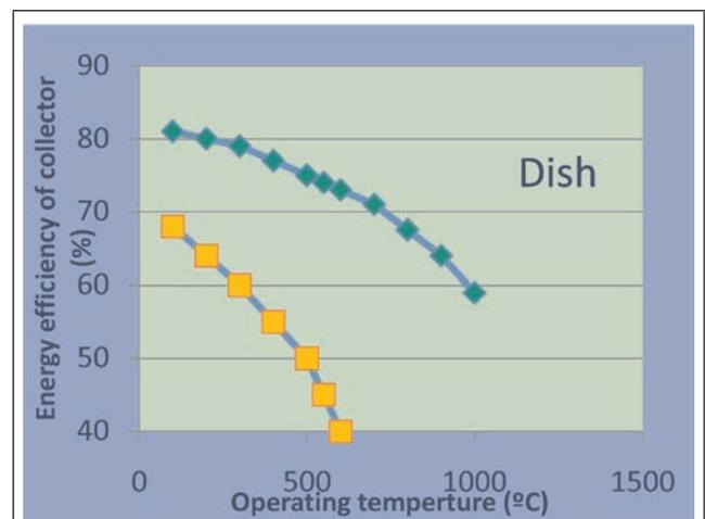
FIG. 1. CONCENTRATING COLLECTOR EFFICIENCY
