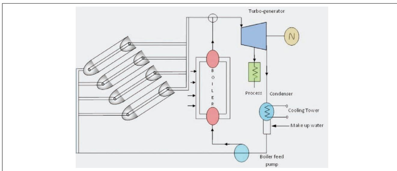
FIG. 8. VIEW OF THE INTEGRATION OF CST SOURCE TO THE POWER BLOCK OF THE SUGAR BASED POWER PLANT.
