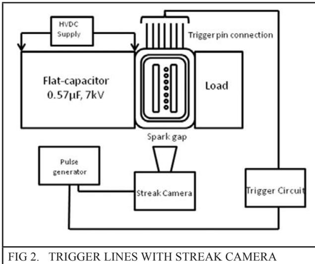
FIG 2. TRIGGER LINES WITH STREAK CAMERA
