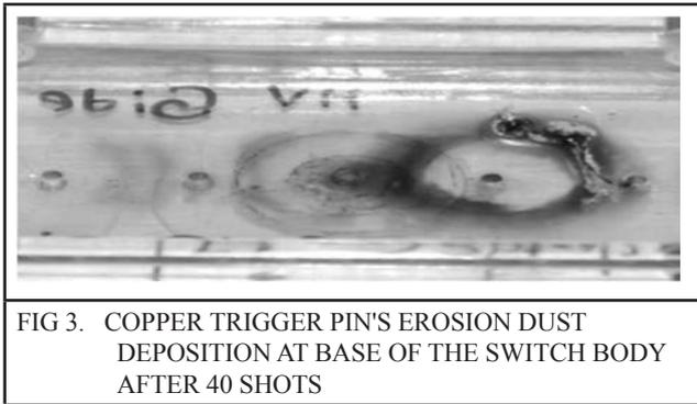
FIG 3. COPPER TRIGGER PIN'S EROSION DUST DEPOSITION AT BASE OF THE SWITCH BODY AFTER 40 SHOTS
