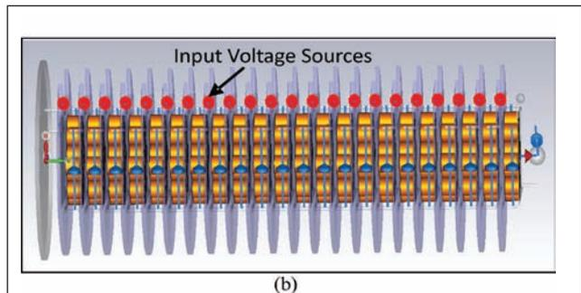
FIG. 3 (B) 22STAGE MARX GENERATOR ON CST MICROWAVE STUDIO
