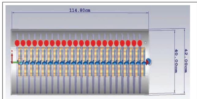
FIG. 4 MARX GENERATOR ON CST MICROWAVE STUDIO WITH ENCLOSURE AS CYLINDER (A = 0CM).
